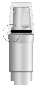
Joint torique sur l'analogue de laboratoire Logfit®
